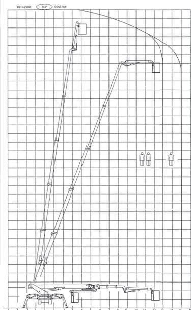
Questo mezzo raggiunge l'altezza di **34 metri** ed è noleggiabile esclusivamente con conducente. Il peso complessivo è di circa 70 q e le misure di piazzamento sono minimo 3,60 x 3,50 m e massimo 4,70 x 4,50 m.
