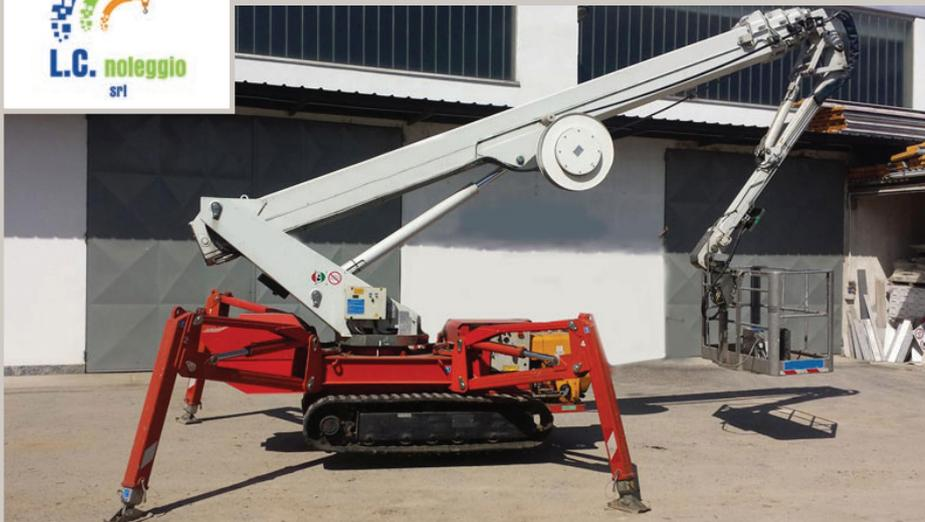
Il ragno Palazzani 19mt, è una piattaforma elevabile installata su carro cingolato semovente. Caratterizzata da eccezionale versatilità, offre la possibilità di lavoro su terreni soffici e pavimenti delicati. Dotato di massima agilità aerea, garantisce ingombro ridotto e stabilità negli spostamenti.
