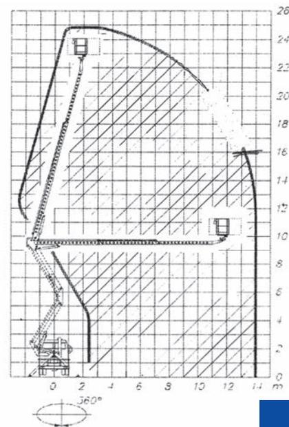
La piattaforma articolata MT 25 si distingue per l'altezza massima raggiungibile, ovvero **25 metri su veicolo PATENTE C**. Il peso complessivo è di 100 q. Socage 25m è montato su Nissan Atleon.
