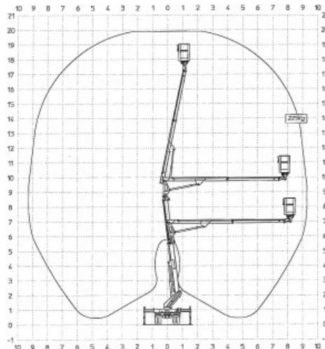
La piattaforma articolata HX 200 EX permette di raggiungere un'altezza massima di lavoro di **20 metri su veicolo PATENTE B**. Disponibile per il **noleggio con e senza operatore**, è caratterizzato da semplicità di utilizzo e dalla stabilizzazione del tipo ad "A". Infatti le traverse degli stabilizzatori possono essere sfilate o retratte dando così la possibilità di avere differenti aree di lavoro.
